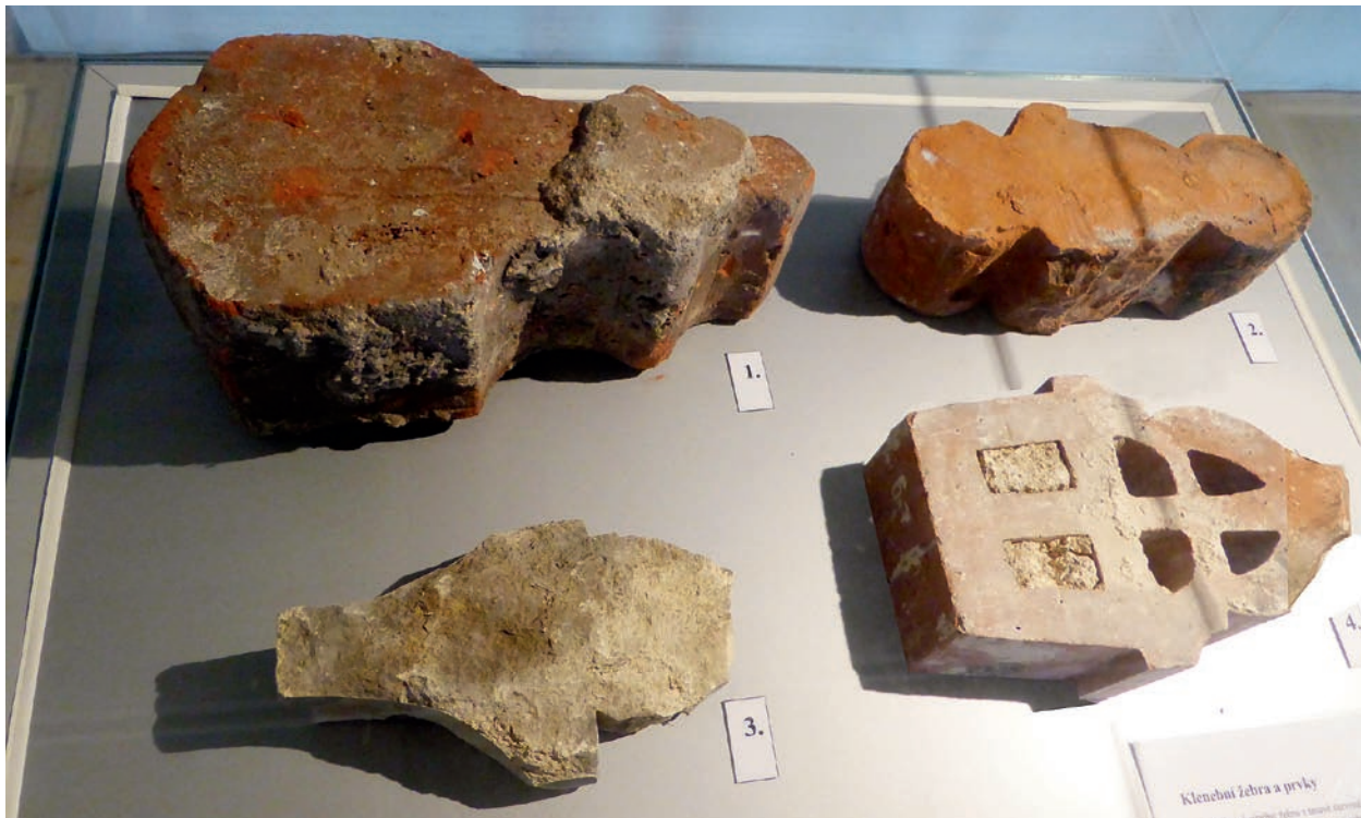
Obr. 88: Pálené tvarovky klenebních žeber: 1 – třetí čtortina 15. století; 2 – druhá třetina 16. století; 3 – opukové žebro ze 14. století; 4 – cihelná tvarovka z Červeného kostela ve Varnsdorfu (1904–1905); NPÚ Krásné Březno.
